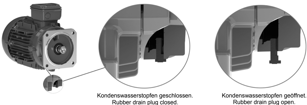
Bild 20: Detail des Kondenswasserstopfens am Lagerschild.
