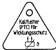
Bild 22: Hinweisschild im Klemmkasten (Farbe: gelb)
